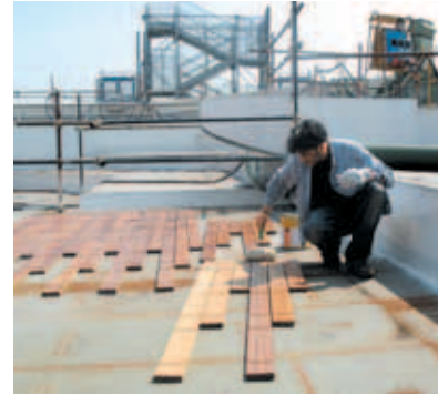
Auftrag von Sika® MultiPrimer Marine mit einer Walze auf ein Teakdeck (Rückseite)
